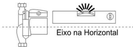
O pressurizador deve ser instalado de modo que o eixo fique na horizontal, conforme figura ao lado.
