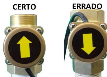
Ao instalar novamente o fluxostato, atentar ao sentido de fluxo de água, pois caso haja uma montagem invertida, poderá ocorrer danos tanto ao pressurizador quanto ao fluxostato.
