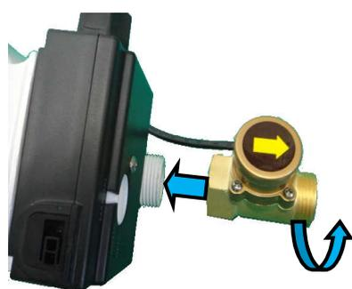
Aplicar fita Teflon na rosca da conexão de saída de água, inserir o fluxostato e realizar o aperto. Atentar ao sentido de fluxo indicado no fluxostato.
