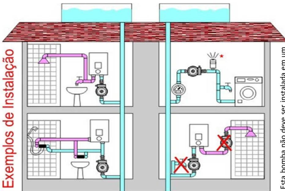
Esta bomba não deve ser instalada em um ambiente com elevado índice de umidade. Os cabos e os componentes elétricos devem permanecer protegidos de algum eventual vazamento no funcionamento e/ou na montagem.
