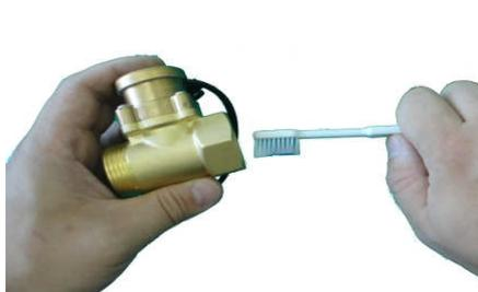
Realizar a limpeza do fluxostato utilizando água corrente e uma escova pequena, para a retirada dos detritos em seu interior.
