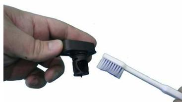
Realizar a limpeza do fluxostato utilizando água corrente e uma escova pequena, para a retirada dos detritos em seu interior.
