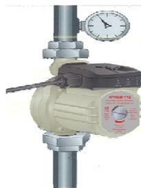
Não ultrapassar a pressão máxima de funcionamento (10 Kgf/cm<sup>2</sup>)
