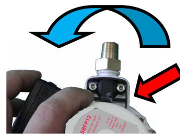
Girar a carcaça do motor até visualizar o fluxostato.
