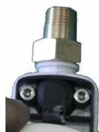
Após a limpeza, instalar novamente o fluxostato em seu alojamento, atentar para a posição de montagem, e em seguida montar a carcaça do motor.
