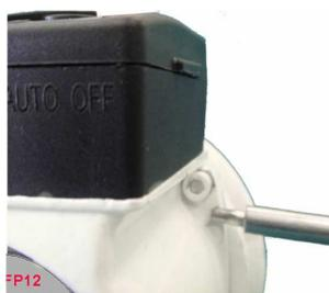
Retirar os quatro parafusos de fixação da carcaça do motor.
