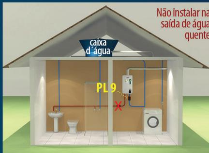
esquema de instalação meramente ilustrativo.
