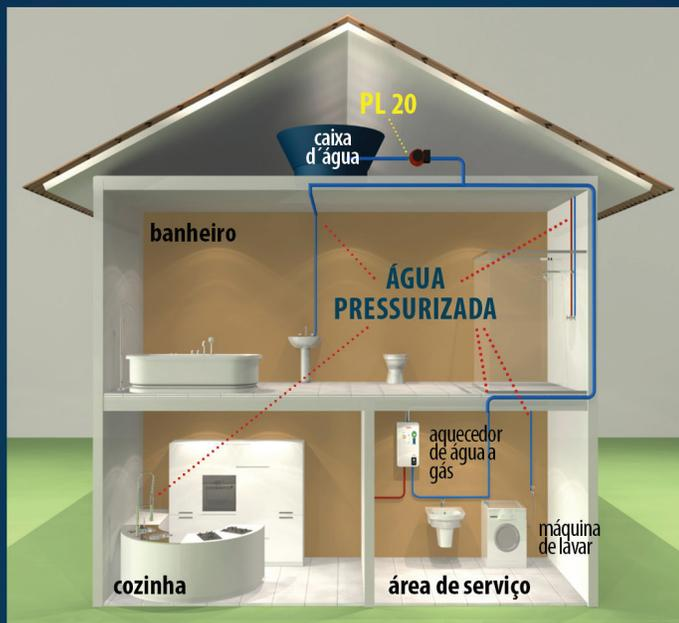
esquema de instalação meramente ilustrativo.
